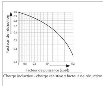
Durée de vie des contacts Charges résistives : 100 000 commutations (déclassement avec charges inductives conformément à la figure)
