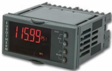
Le modèle 32h8e, de format horizontal 1/8DIN assure deux fonctions : celle d'afficheur déporté pour l'EPower et celle d'unité d'alarme indépendante ('policeman'). Cette dernière a pour vocation de couper la puissance en cas de surtempérature (ou en tout autre cas de condition excessive sur le procédé). Le 32h8e communique avec l'Epower en protocole Modbus, via le bus EIA 485 (connecteur RJ45 situé sur le dessous du module contrôle de l'EPower).
